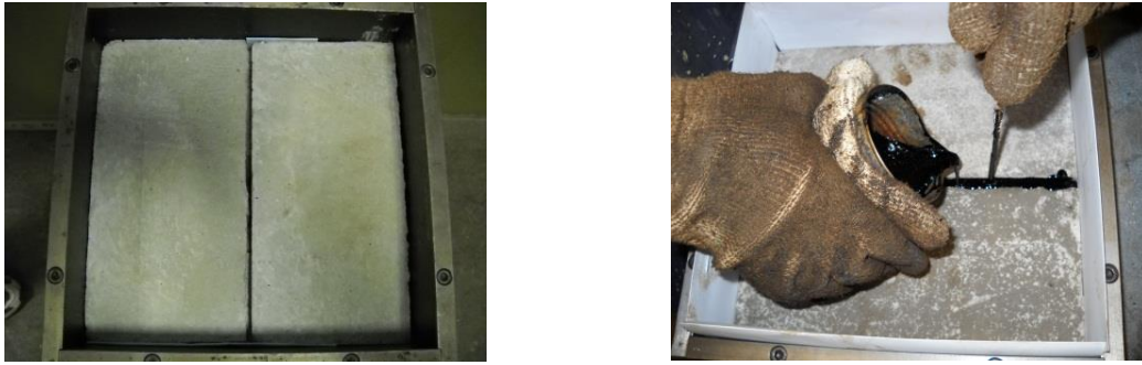
Figura 7. Placas de hormigón, sellado de junta
