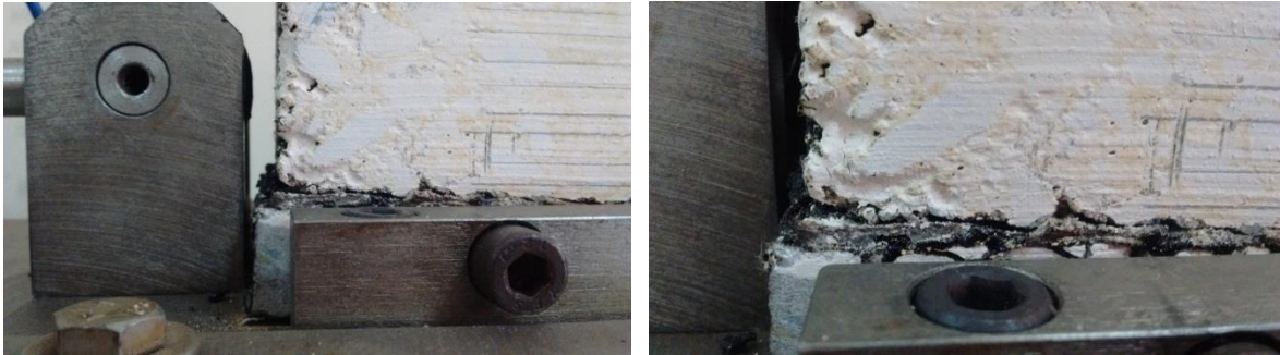
Figura 14. Desplazamiento en la interfase con la placa de hormigón
