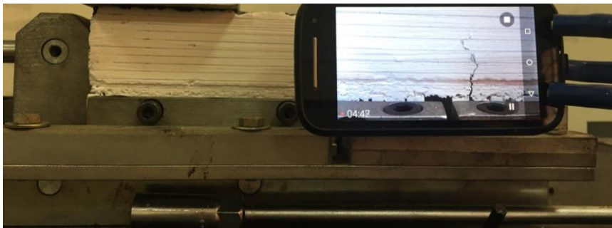
Figura 18. Seguimiento de la propagación de fisura.
